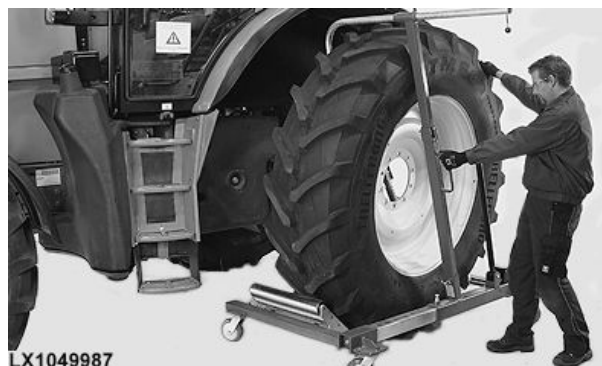
KJD10581—Тележка для перевозки колес JT02043—Опорная стойка, 482—736 мм (19—29 дюйм.)
