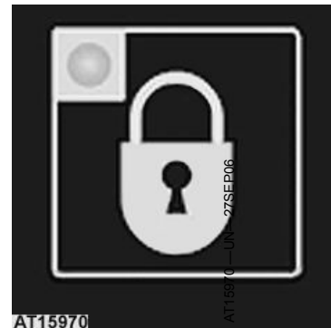
Prekidač blokade pri transportu (sa crvenom lampicom)
