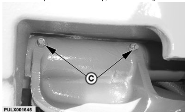
Pöördetapi määrdenippel — ilma esisillaveota traktorid
