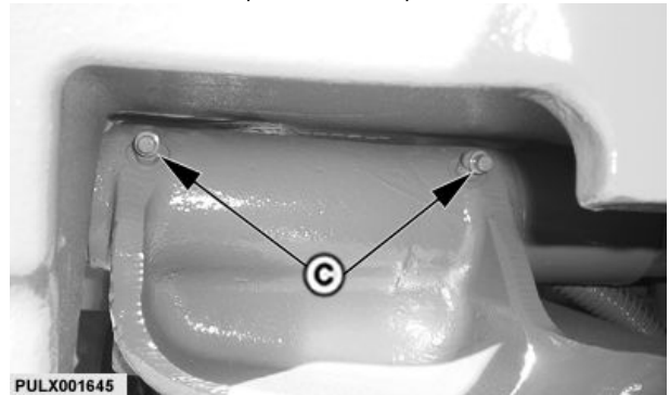
Tlaková maznice ložiskového čepu – traktory bez přední hnací nápravy
