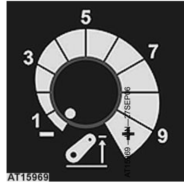
Ovládač paměti pro maximální výšku zdvihu
