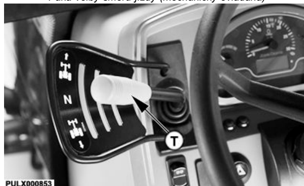
Páka volby směru jízdy (elektricky ovládaná)
