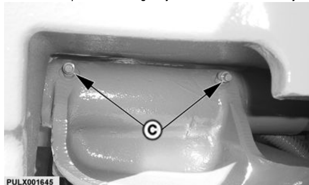
A billenőcsap zsírzógombja — traktorok elsőkerék-hajtás nélkül
