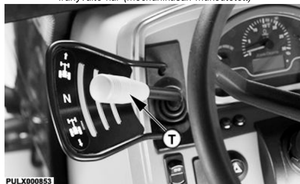
Írányváltó kar (elektromosan működtetett)
