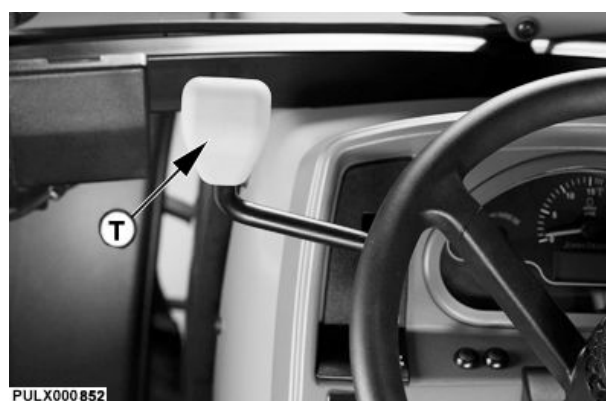
Írányváltó kar (mechanikusan működtetett)
