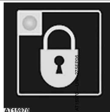
Szállítási reteszelő kapcsoló (piros LED-del)
