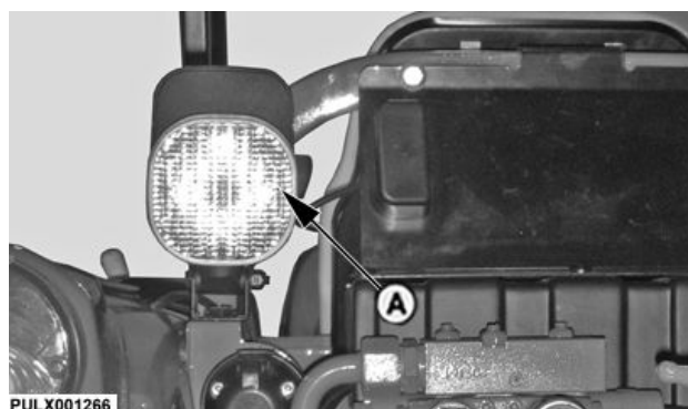
Światła robocze, ciągnik bez kabiny
