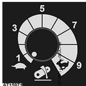
Przełącznik sterowania prędkością opuszczania
