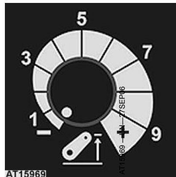
Przełącznik pamięci ograniczenia wysokości
