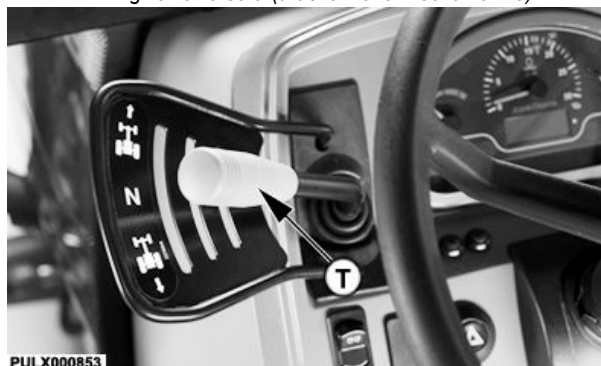
Dźwignia rewersera (uruchamiana elektrycznie)
