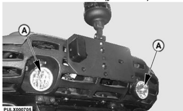
Światła robocze, ciągnik z kabiną
