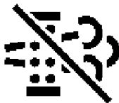
ICONCC059—UN—06JUN13 Limpieza automática del filtro del escape no activada
