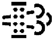
ICONCC058—UN—06JUN13 Nettoyage automatique du filtre à gaz d'échappement activé
