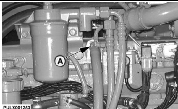
A—Udluftningsrøret på krumtaphuset
