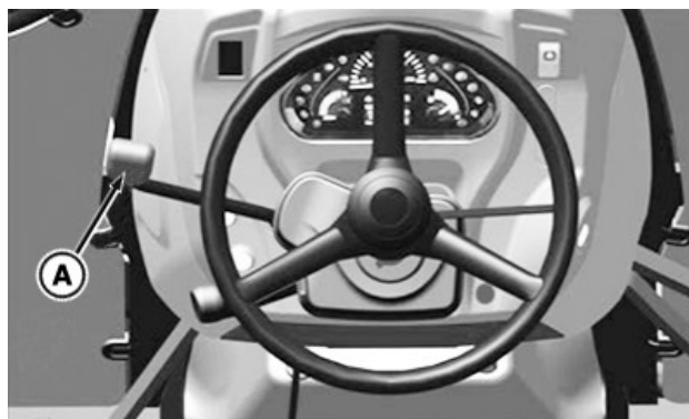
Palanca del inversor (accionamiento mecánico) (5GV, 5GN, 5GF)
