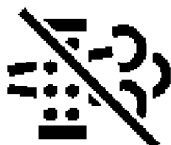
ICONCC059—UN—06JUN13 Limpieza automática del filtro de escape no activada
