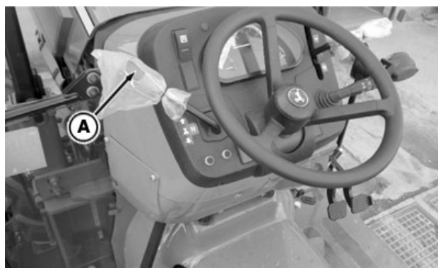
Palanca del inversor (accionamiento mecánico) (5GL y 5GL-N)
