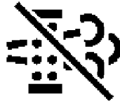
ICONCC059—UN—06JUN13 F2 - Inhibición de regeneración
