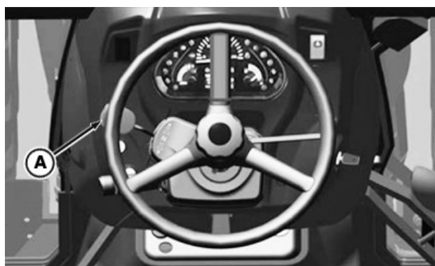
Palanca del inversor (accionamiento eléctrico) (5GV, 5GN, 5GF)
