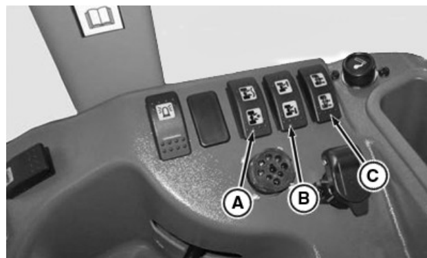
A—Stikalo za spodnje vzvode – nastavev položaja za nihanje B—Stikalo za spodnje vzvode – premik levo/desno C—Stikalo za droge hidravličnega valja – izpeljava/vpeljava
