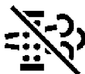
ICONCC059—UN—06JUN13 Automatické čistenie filtra výfukových plynov nie je aktivované
