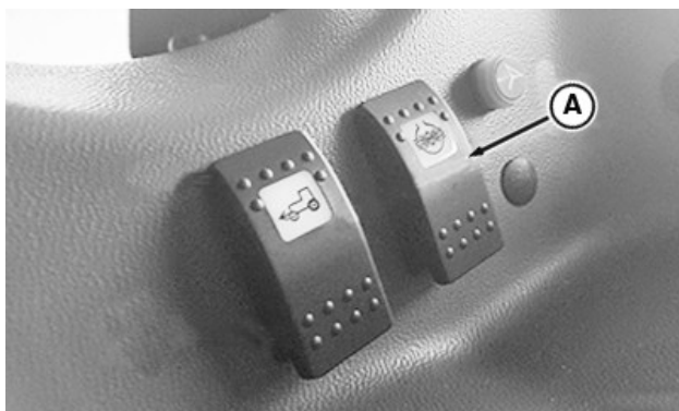
A—Spínač uzáveru diferenciálu
