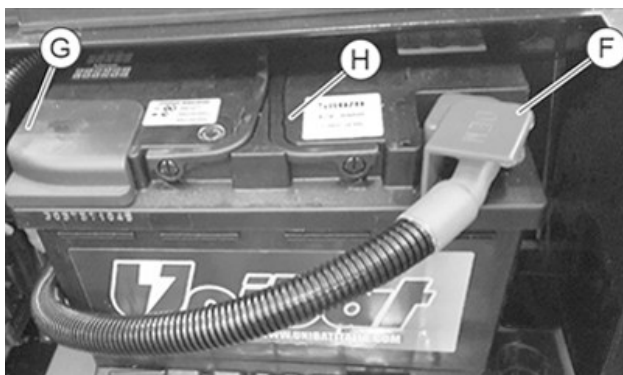
F—Kábel kladného pólu batérie G—Záporný kábel (ukostrenie) batérie H—Batéria
