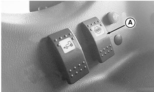
A—Comutatorul de blocare a diferențialului
