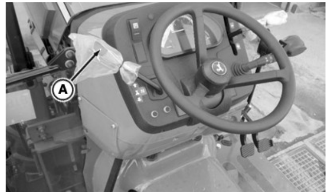
Maneta de marșarier (acționată mecanic) (5GL și 5GL-N)
