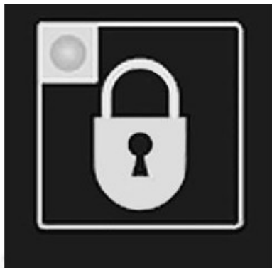
Comutatorul de Blocare pentru Transport (cu LED Roșu)
