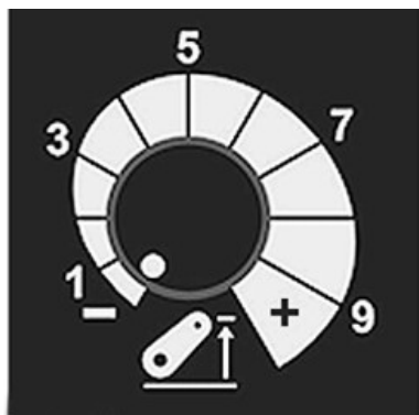
Comutatorul de memorare a limitei de înălțime
