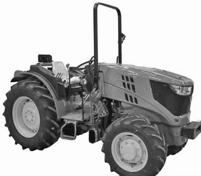
(Estação do Operador Aberta) (5GF)
