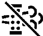
ICONCC059—UN—06JUN13 Limpeza automática do filtro de exaustão não ativada
