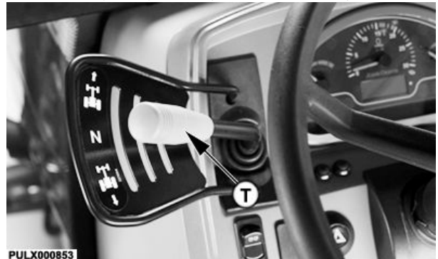
Rijrichtingshendel (elektrisch bediend)
