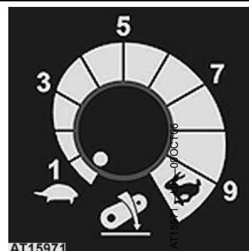
AT15971 Schakelaar regeling daalsnelheid
