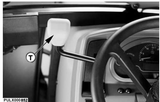
Rijrichtingshendel (mechanisch bediend)
