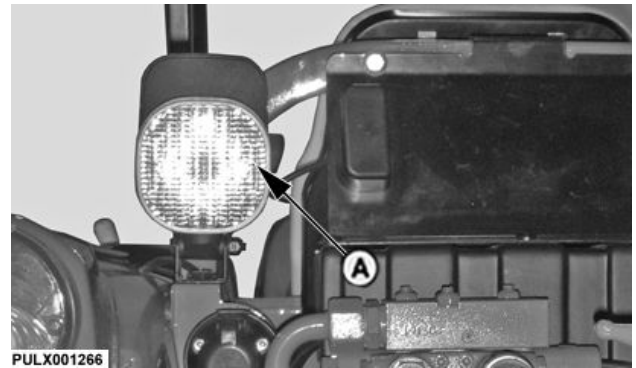
Werklicht, trekker zonder cabine
