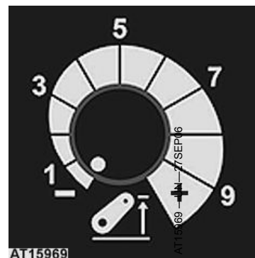
AT15969 Schakelaar instelling hoogtebeperking
