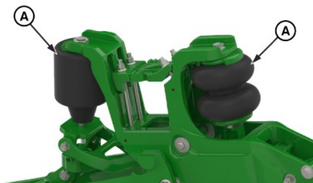
Molas Pneumáticas PDF das Unidades de Linha de Fertilizante
