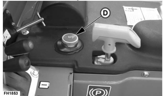
Hydraulic Fill Port
