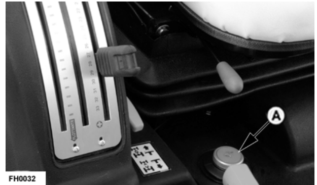
A—Varilla de nivel de aceite hidráulico y de la transmisión
