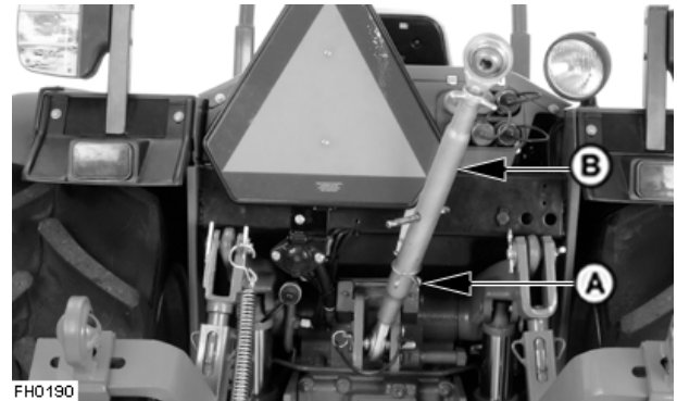
A—Pinza de bloqueo B—Cuerpo del tensor central C—Palanca de bloqueo D—Soporte
