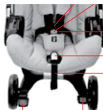
14. דווש נעילת מעצור (אדומה) 15. דווש שחרור מעצור (ירוקה)
