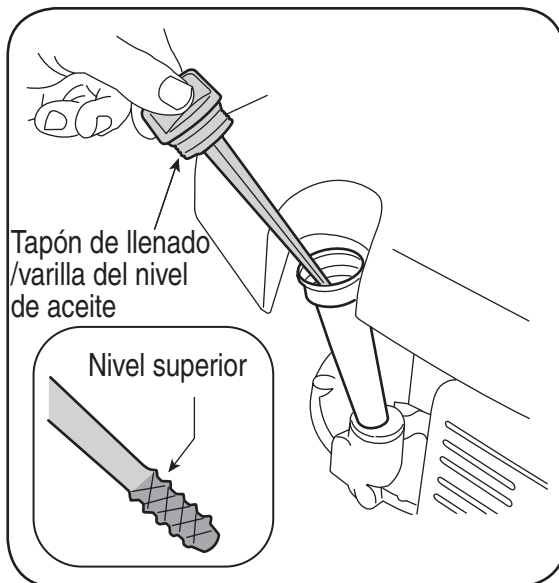
Figura 9-2: Verificación del nivel de aceite
