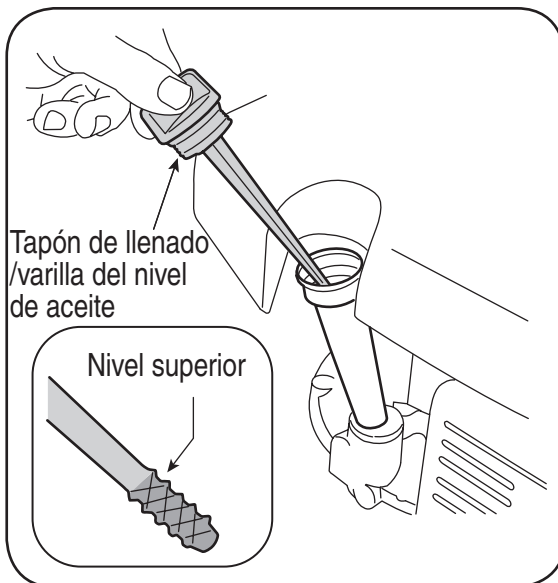
Figura 9-2: Verificación del nivel de aceite
