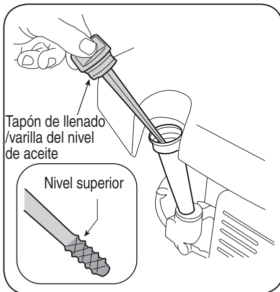
Figura 9-2: Verificación del nivel de aceite
