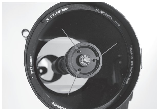
Vis de collimation du miroir secondaire
