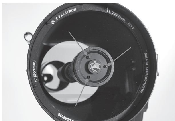
Tornillos de ajuste de colimación del espejo secundario
