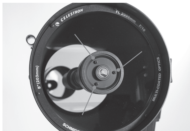
Kollimationsjustagen für den Sekundärspiegel
