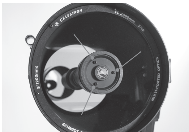
Collimazione dello specchio secondario regolando le viti
