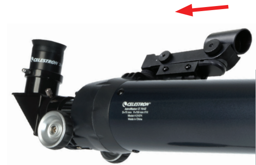
Sucherfernrohr in einem Refraktorteleskop
