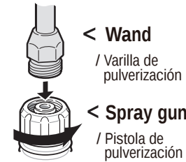
Connect wand to spray gun / Conecte La varilla de pulverización a la pistola de pulverización
