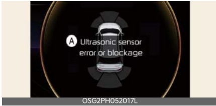
A: Ultrasonic sensor error or blockage
