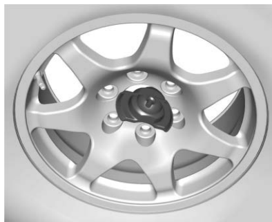
Tous les autres modèles, rangement incorrect, dispositif de retenue décentré
