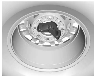
Modèle ZR2, rangement incorrect, dispositif de retenue décentré
