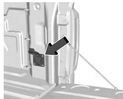
Tomacorriente de plataforma de camioneta
