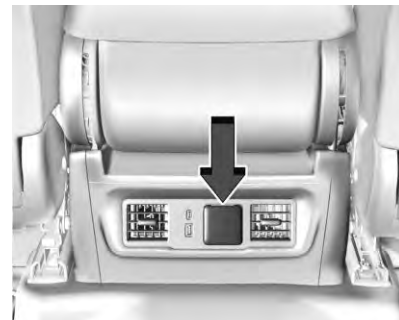
Parte trasera de tomacorriente de consola central
