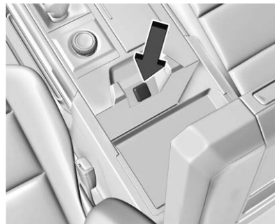
Center Console 12 Volt Power Outlet
