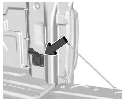
Tomacorriente de plataforma de camioneta
