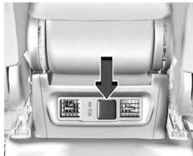
Parte trasera de tomacorriente de consola central.
