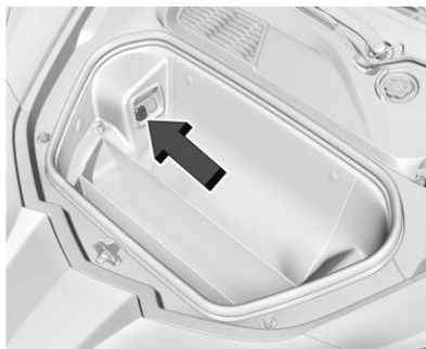
Tomacorriente debajo del cofre
