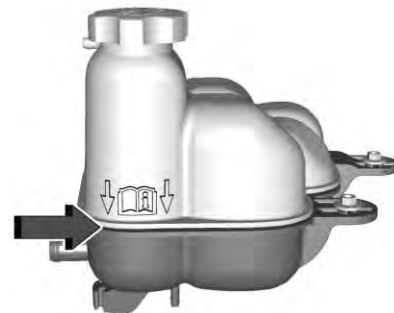
Tanque de compensación de Refrigerante del motor 2.0L I4 y Motor 3.0L V6
