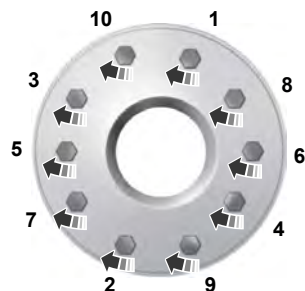
10-lug nut torque sequence
