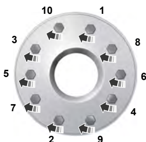
10-lug nut torque sequence
